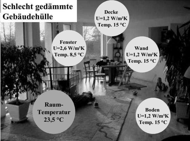
**Abb. 5: Oberflächentemperaturen bei einer schlecht gedämmten Gebäudehülle**
