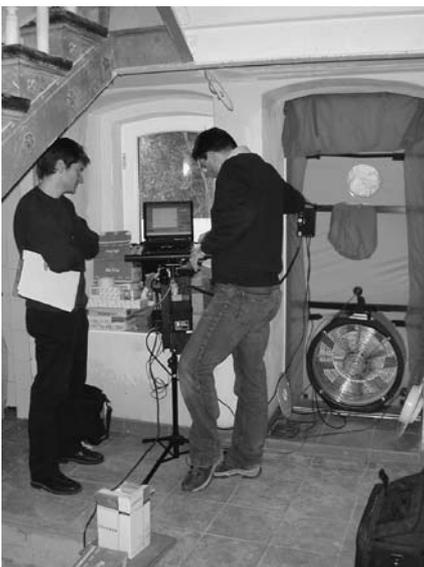
Blower-Door-Test zur Prüfung der Luftdichtigkeit
